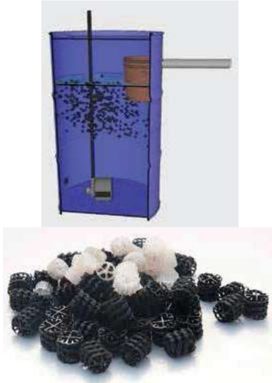
Gambar 1.2 Diagram unit biofilter skala kecil dan media biofilternya
